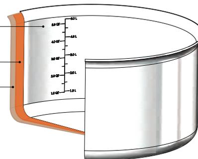
Edelstahl ist kein guter Wärmeleiter, deshalb bieten wir ein mehrlagiges Produkt in dieser Serie an. Die zentrale Aluminiumlage ermöglicht eine gleichmäßige und effiziente Hitzeverteilung.
